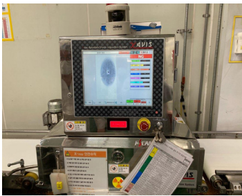
X-ray 검출기(좌)/금속검출기(우) 이물제어 테스트: 모두 검출
